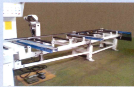
送り込み延長ロール式定盤及び定規、 送り込みピンチロール 幅寄せデバイダー
