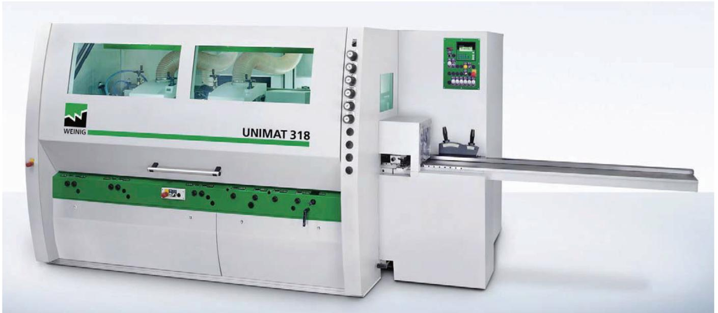
比較的省スペース設計のこのモルダーは、加工の柔軟性が高い強力な機構を装備しています。全軸独立モーターにより、パワフルな加工も柔軟に対応します。オプションも豊富で生産の幅が広がります。
