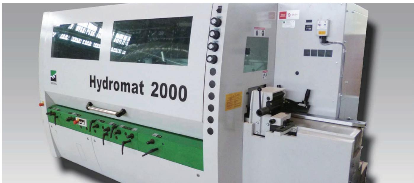
大量生産向けの高速モルダーです。インバーター制御により送り速度を自由に設定でき、送り速度を最速 60 m / 分まで上げることができます。高速送り用に軸の回転数も 8,000RPM に設定されており、最高の仕上がり肌が得られます。
